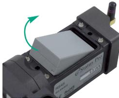
Achten Sie beim Einsetzen des Akkus auf die Kontakte. Nur wenn diese nach unten und zum Geräteende hin zeigen, besteht ein Kontakt. Ein Einsetzen des Akkus in verkehrter Richtung ist nicht möglich, da der Akku an seiner Kontaktseite zwei Aussparungen hat, welche die Lage vorgeben. Versuchen Sie nicht, den Akku mit Gewalt einzusetzen! Ist dies erforderlich, wurde er falsch eingeführt.
