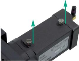
An der Oberseite des R545 befinden sich zwei Rändelschrauben, die das Akkufach verschließen. Diese können herausgedreht (verbleiben am Akkufachdeckel) und der Deckel kann entfernt werden. Darunter befindet sich der Akku. Durch leichtes Anheben an der Akkuseite, die nach vorne zeigt, kann der Akku nach oben aus dem Gehäuse entfernt werden.
