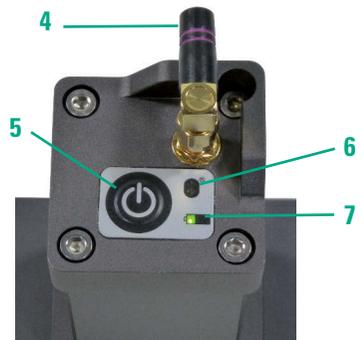
Die Akkuanzeige (7) zeigt den Zustand des Akkus im Betrieb an:
