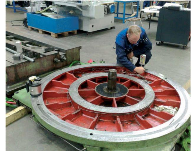
La misurazione della planarità delle flange, in particolare se di elevate dimensioni e ove si richieda un perfetto accoppiamento, richiede specifiche attenzioni.
