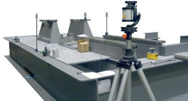
Il sistema autolivellante **T330** crea un piano laser di riferimento immediatamente livellato, mentre il ricevitore **R310** misura l'altezza rispetto a questo piano. La misura è leggibile direttamente sul display integrato o su PC. Grazie al software **ProLevel** è possibile visualizzare i punti rilevati su tabella Excel, su un grafico 2D operando su più piani, o 3D.
