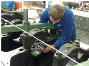
Grazie ad una misura su n-punti, un sensore wireless dotato di inclinometro integrato, consente un allineamento estremamente affidabile. Tramite apposito software si controlla:
