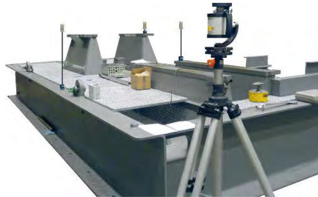
Präzise Nivellierung mit nur einer Person durchführen? Mit Hilfe des Status Pro Level Systems sind Sie in der Lage in wenigen Schritten Ihre Anlagen oder Führungsbahnen exakt auszurichten.
