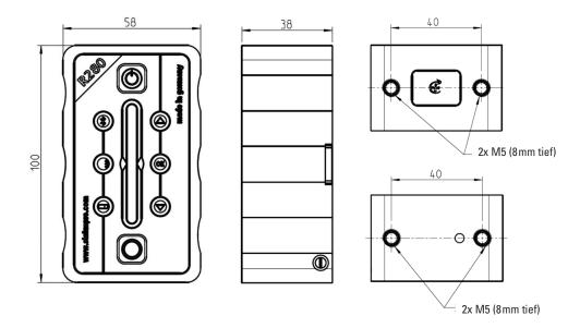
Der R280 misst die Position des rotierenden Laserstrahls wie eine Messuhr den Abstand von dem Werkstück zur Referenz. Der Laserstrahl bildet eine ganze Referenzebene und nicht nur eine Linie wie ein Draht. Der R280 hat eine Reichweite von bis zu 80 Metern, eingebautes Bluetooth und einen wechselbaren Li-Ion Akku für 8 Stunden Messzeit.
