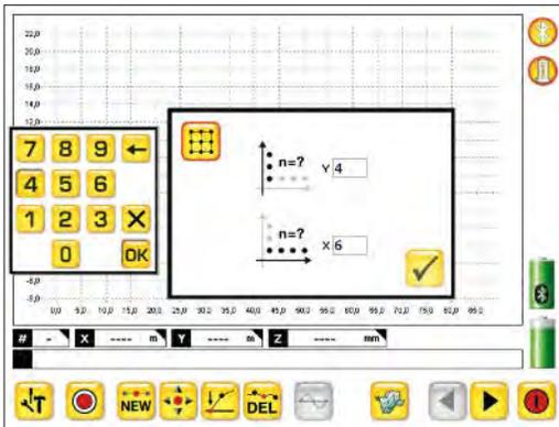
在X轴与Y轴上定义测量点的个数，定义后点击“✓”完成方形测量平面的设置。
