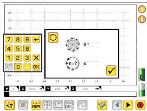
定义测量物体圆心角的度数或者弧长上测量点的个数，定义后点击“✓”完成圆形测量平面的设置。
