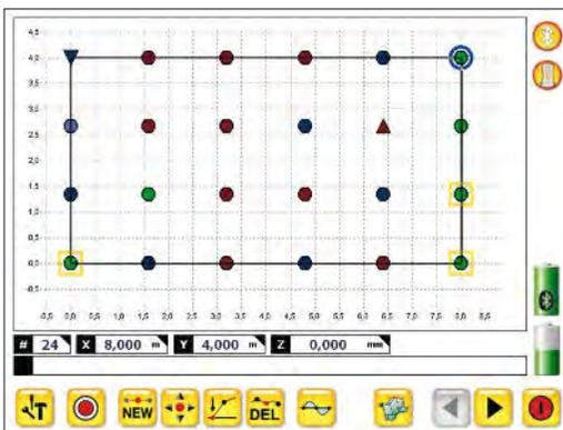
通过点击操作栏中的“
