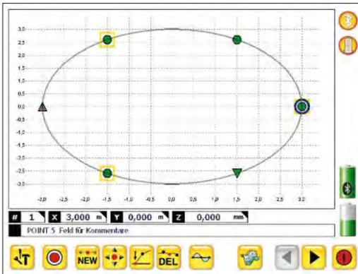
通过点击操作栏中的“X”图标,可将平面中任意一点的测量值归零。通过点击操作栏中的“Z”图标,软件 ProLevel V2会为已测量的数据自动分析出最佳的参考平面。
