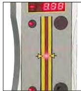
3. 将激光接收器摆放至待测量位置,调整T330三脚架的高度,使T330的旋转激光位于激光接收器的电子零界线上(即传感器的中央)。
