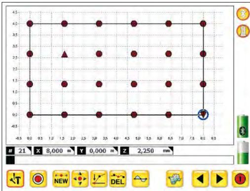
已记录的测量点会以彩色记录点的形式在图像显示视窗中显示出来。高于允许误差范围之外的测量点显示为红色圆形。最大值显示为红色正三角形。在允许误差范围内的测量点显示为绿色圆形。低于允许误差范围之外的测量点显示为蓝色圆形。最小值显示为蓝色倒三角形。
