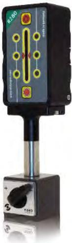
R280使用感光耦合元件 (CCD) 作为接收传感器, 其测量的高度范围为40毫米。R280可以在室温为0到50度的范围接收到80米之内由T330发出的旋转激光, 其分辨率为10微米, 其精确度为 $\pm 0.02 + 0.3\%$ 的直线度。R280上具有远程测量记录按钮, 以此可以快速便捷地远程采集测量数据。R280拥有蓝牙装置, 以此使其远程与软件相连接并进行数据传输。通过电池可给R280和蓝牙装置供电并可维持长达8小时的测量时间。
