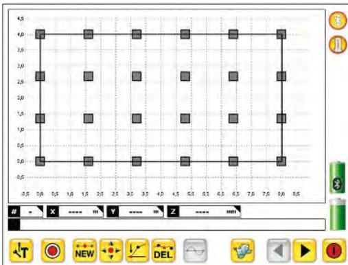
设置好的方形测量平面会在主页面中显示出来。在设置好的平面内，首先点击选择测量点的位置，然后将激光接收器放置在测量物体相对应的位置上，便可采集该点的测量数据。
