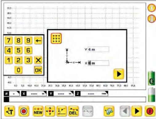
定义测量物体的长度（即X轴）与宽度（即Y轴），定义后点击“▶”进行下一步设置。
