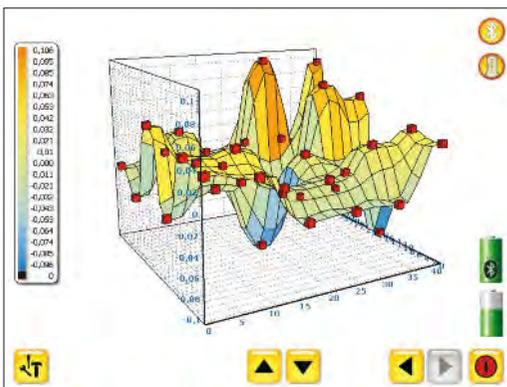
通过点击操作栏中的“Z”图标,测量数据会以三维图形显示出来,通过点击“▲▼”三维图形将会被放大或缩小。
