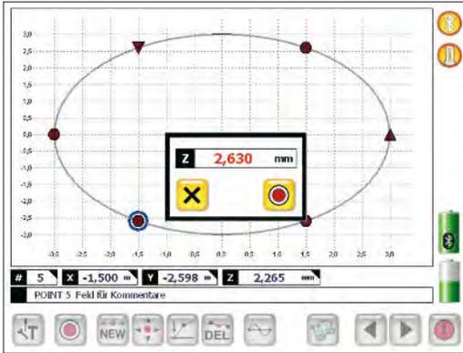
设置好的圆形测量平面会在主页面中显示出来。在设置好的平面内,首先点击选择测量点的位置,然后将激光接收器放置在测量物体相对应的位置上,便可采集该点的测量数据。
