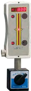
R310使用感光耦合元件 (CCD) 作为接收传感器, 其测量高度范围为80毫米, 测量值可直接显示在R310的屏幕上。R310可在室温为0到50度的范围接收到80米之内由T330发出的旋转激光, 其分辨率为10微米, 其精确度为 $\pm 0.02 + 0.3\%$ 的直线度。该接收器不但拥有蓝牙装置而且拥有红外线装置, 其红外线的接收范围是50米。通过蓝牙使其与软件相连接并进行数据传输。通过红外线信号能自动调试T330的旋转激光, 并可将实时调整值通过红外线信号显示在遥控器RC310上。通过电源或电池可给R310和蓝牙装置供电。
