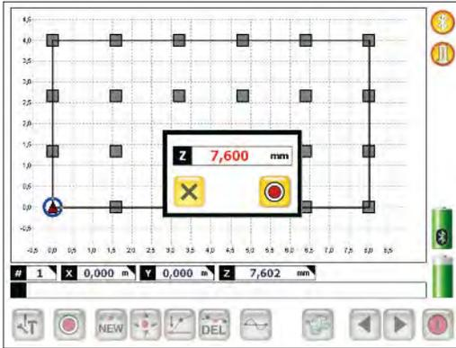
在设置好的平面内, 首先选择测量点的位置(测量位置无先后的顺序要求), 然后将激光接收器放置在测量物体相对应的位置上, 点击操作栏中的“
