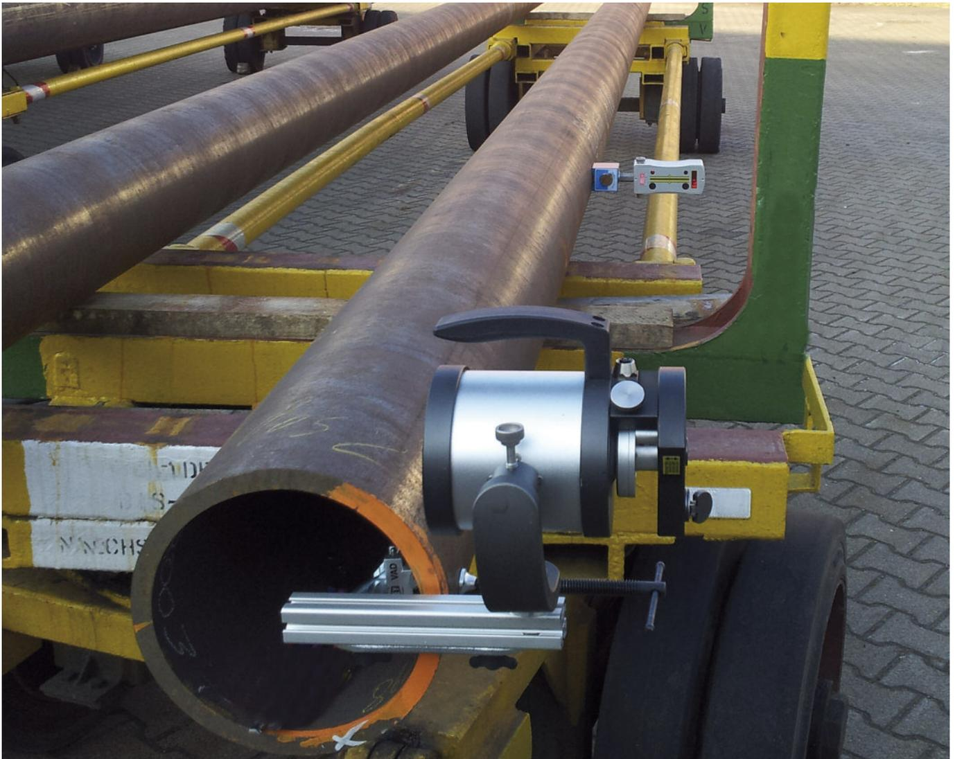
Die Vermessung von Rohren dient zur Sicherstellung einer hohen Fertigungsqualität. Für jedes Rohr kann ein kurzes Messprotokoll angefertigt werden, das die Geometrie (Geradheit) des Rohres wiedergibt.
