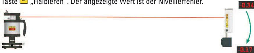
Nach der Nivellierprobe sollten Sie abschätzen, ob die Genauigkeit für die folgende Messung ausreicht, ansonsten kalibrieren.
