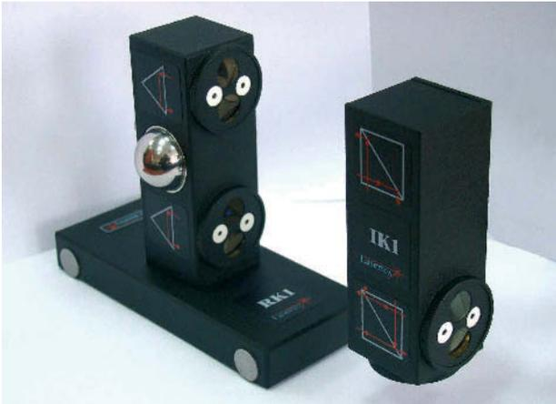
Die Geradheitsmessung kann zur Erhöhung der Genauigkeit mit der Kippwinkeloptik durchgeführt werden. Dazu wird das Interferometerelement IL1 durch IK1 und das Reflektorelement RL1 durch RK1 ersetzt. Auf Abbildung 59 sind die beiden Komponenten abgebildet, die verwendet werden.
