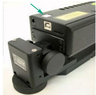
Abb. 1: Einschaltknopf Interferometer
