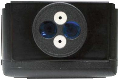
Drehen Sie die Zieloptiken am Interferometer und dem Reflektorelement so, dass die weißen Flächen in einer waagerechten Ebene stehen, wie auf Abbildung 15 am Beispiel des Interferometers dargestellt. Der unteren Abbildung entspricht dabei der Zustand, den Sie zum Ausrichten verwenden müssen, der obere Zustand muss für die Messung eingenommen werden.
