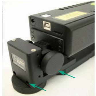
Abb. 11: Stellschrauben Neigungs-ausrichtung
