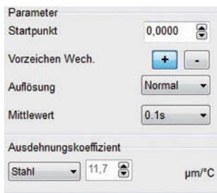
Im Feld „Parameter“, Abbildung 9, müssen Sie den Mittelwert über den Drop-Down-Button auswählen. Unter normalen Umständen sollten Sie hier „0.1s“ einstellen. Für die Temperaturkompensation ist außerdem der Ausdehnungskoeffizient wichtig. Wählen Sie dafür den Werkstoff der zu vermessenden Achse aus (bei Werkzeugmaschinen überwiegend *Stahl*).
