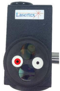
Abb. 26: Ausrichtung Interferometerelement
