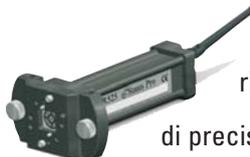
L'**R525** è un ricevitore laser di precisione su due assi, alimentato a batteria e senza fili, per la misurazione precisa della rettilineità delle guide delle catene di trasporto. Esso permette di effettuare misure su una guida di 30 metri, a step di 50mm, visualizzarle e memorizzarle nel PC portatile. Il tutto nel giro di 5 minuti (vedi figura sopra).
