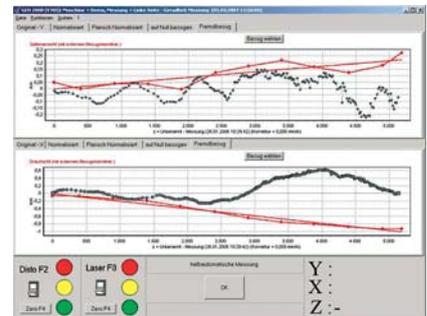
**GEO 2000** creato appositamente per il montaggio di profilatrici doppie, è stato ottimizzato nel corso di quattro anni in collaborazione con specialisti di assistenza e montaggio. Il suo punto di forza è la contemporaneità di lettura dei valori X,Y e Z. Geo viene fornito insieme con l'unità di display NMPC.
