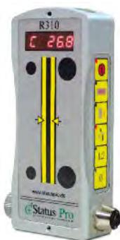
Der R310 misst die Position des rotierenden Laserstrahls wie eine Messuhr den Abstand von dem Werkstück zur Referenz. Der Strahl bildet eine ganze Referenzebene und nicht nur eine Linie wie ein Draht. Der R310 hat eine Reichweite von bis zu 80 Metern, ein Display und eine Tastatur zur vollständigen Steuerung auch ohne Software. Zur Softwareanbindung optional mit Bluetooth zu erhalten.
